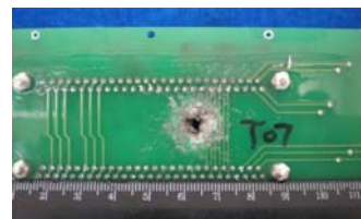
(b) 热控设备的超高速撞击试验
