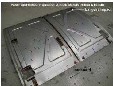
图 7 气闸舱防护屏的回收实物
