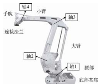
图9 用于卫星舱板装配的机器人结构
