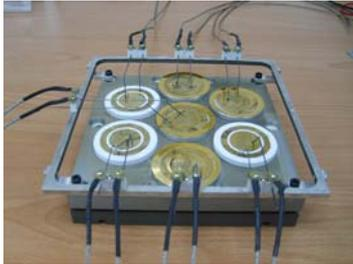
图2 表面电阻率原位测试布置图
