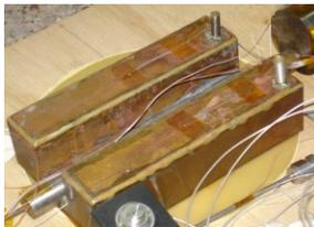
图5 带有相变材料的蒸发器
