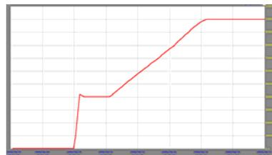
图 3 第一类技术要求复压过程真空度曲线
