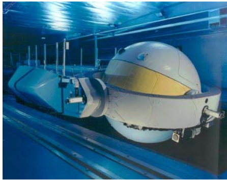
图 4-75 安装前的瑞典空军 DFS 转臂与座舱 Fig. 4-75 Swedish Air Force DFS Arm and Gondola Before Installation
