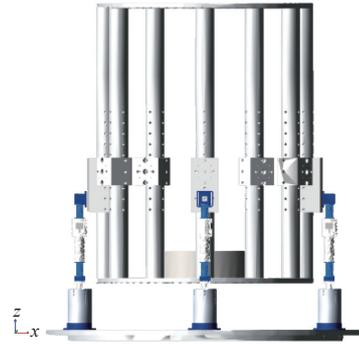
图 10 ADAMS 建立的隔振与指向一体化平台的刚柔耦合模型
