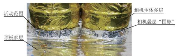
图3 相机多层与舱板多层搭接安装照片
