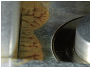
图 9 开关按钮润滑脂溢出现象
