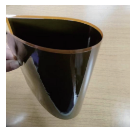
图 3 弯折状态下的封装石墨薄膜 Fig. 3 A bent packaged graphite film
