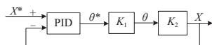
图 9 位移闭环控制系统动态结构 Fig. 9 Dynamic structural diagram of displacement closed-loop control system
