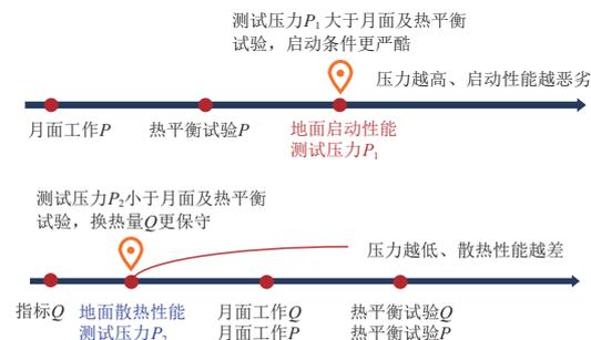
图5 高温水升华热排散系统地面性能测试方法示意
