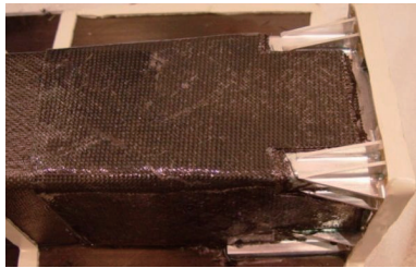
图 7 接头区胶接复合材料补片加强形式 Fig. 7 Configuration of composite patch in the joint area
