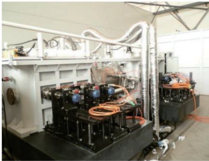
图 3 谐波减速器真空高低温性能测试装置 [48]
