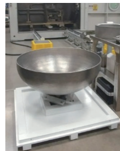
图 28 3D 打印的贮箱构件
