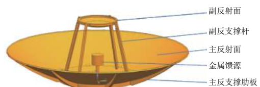
图 1 网状天线结构示意图
