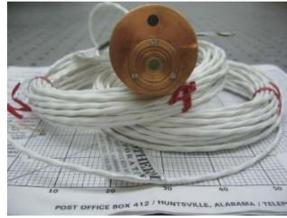
图 3 S-B 型热流计结构及实物
