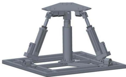
图 7 推杆推力仿真模型
