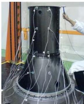
图 7 承力筒 II 采用固支法的模态试验现场图
