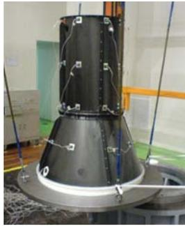
图12 承力筒II采用悬挂法的模态试验现场图
