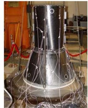
图 5 承力筒 I 采用悬挂法的模态试验现场图
